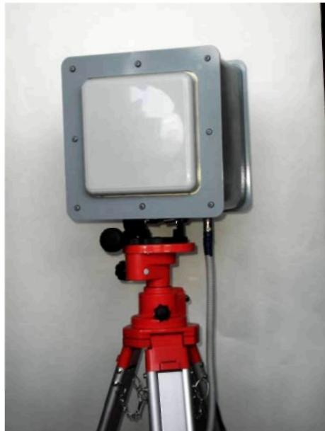
Для проведения метрологической поверки комплекса без его демонтажа с места установки разработан и изготовлен «Имитатор транспортного средства».
